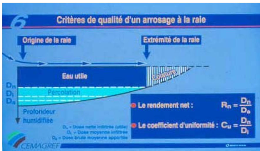
Figure 6. Illustration des critères de performance en irrigation à la raie ( R_n est aussi appelé efficacité)
