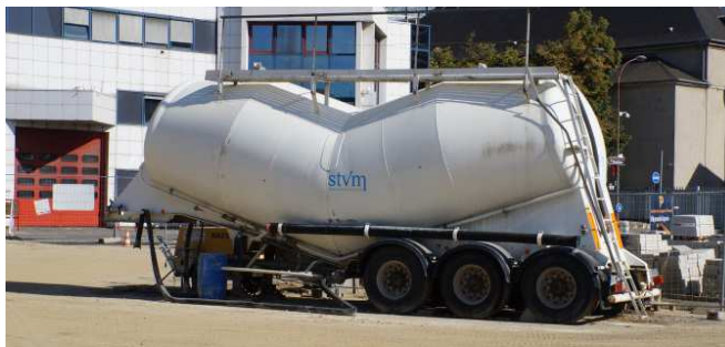
Remorque contenant la chaux nécessaire au traitement des matériaux
