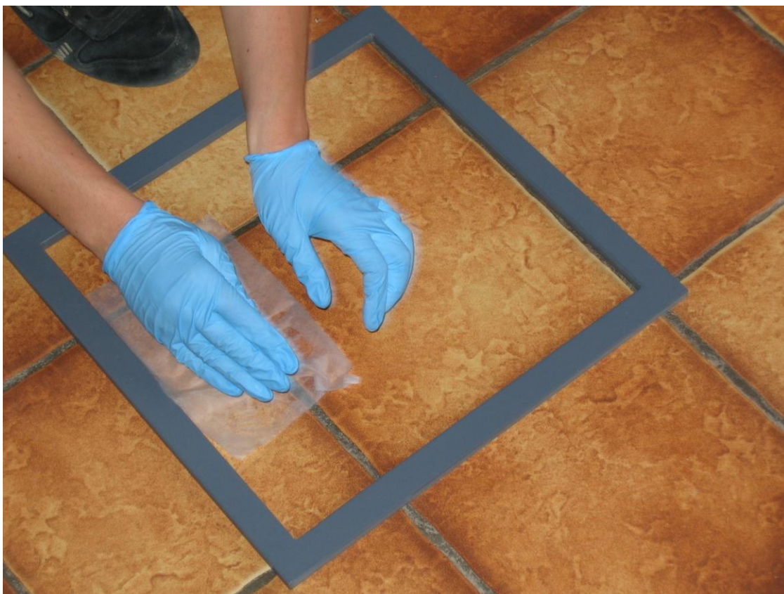
Figure 6 : Prélèvements de poussières par lingettes
