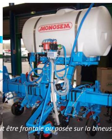
Pour le désherbinage du maïs, le kit de pulvérisation est disposé sur la bineuse et la cuve peut être frontale ou posée sur la bineuse
