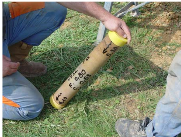
Illustration 13 : vue générale d'une colonne de sol chemisée, obturée et référencée
