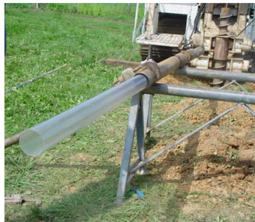
Illustration 12 : gaine de prélèvement PVC engagée dans le tube échantillonneur
