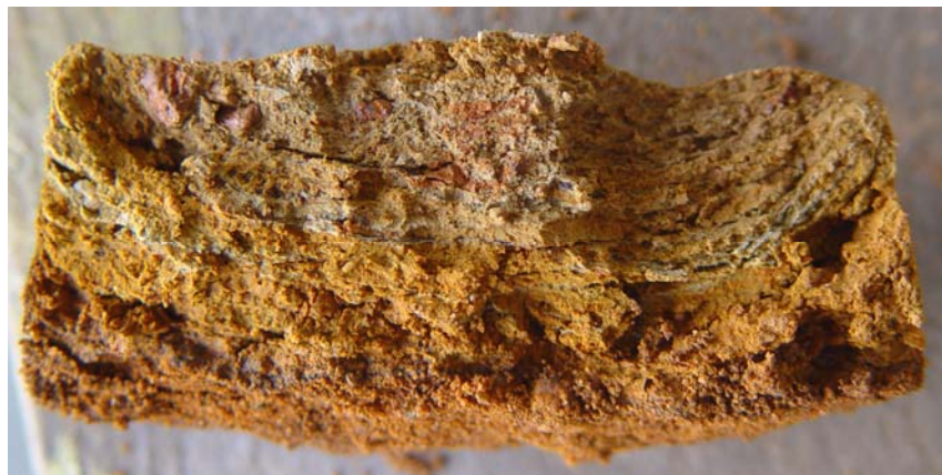
Illustration 23 : Coupe détaillée d'une colonne de sol de 5 cm de hauteur prélevée par tarière creuse lors d'un forage d'essai sur V95 et montrant la déformation des horizons
