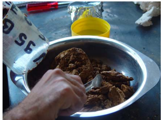
Illustration 16 : Homogénéisation des échantillons de sol
