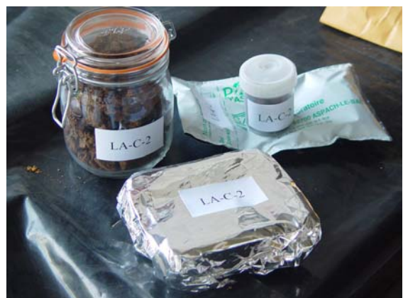
Illustration 17 : Conditionnements des échantillons de sol
