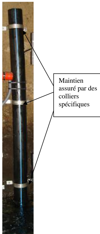
Fixation d'une gaine de protection pour les câbles des transducteurs
