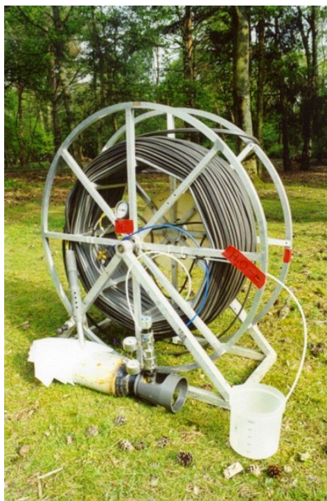
Figure 40 : un exemple de préleveur mobile avec 300 m de bitube rilsan protégé par une membrane sur touret de capacité 600 m, et bouteille portable d'azote sous pression.
