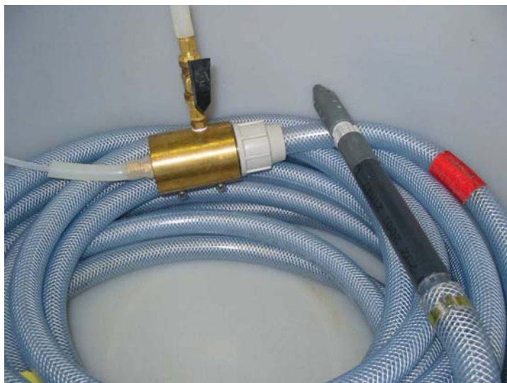
Figure 39 : un exemple de système d'échantillonnage de conception BRGM composé d'une tête laiton, d'un tuyau double protégé par un tuyau PVC (montage adapté aux faibles profondeurs qui est remplacé par un bitube rilsan protégé par une membrane comme ci-dessous) et d'un tube de prélèvement (remplacé par une bouteille inox de volume plus important).
