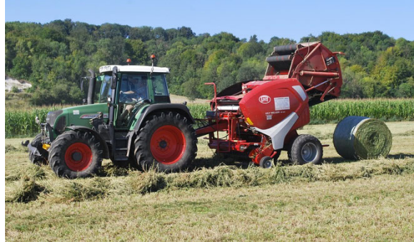
Figure 23 : Exemple d'une presse à balle ronde. ©Pixabay
