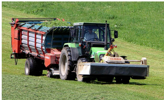
Figure 26 : Barre de coupe frontale à disques à l'avant et autochargeuse à l'arrière. ©Pixabay
