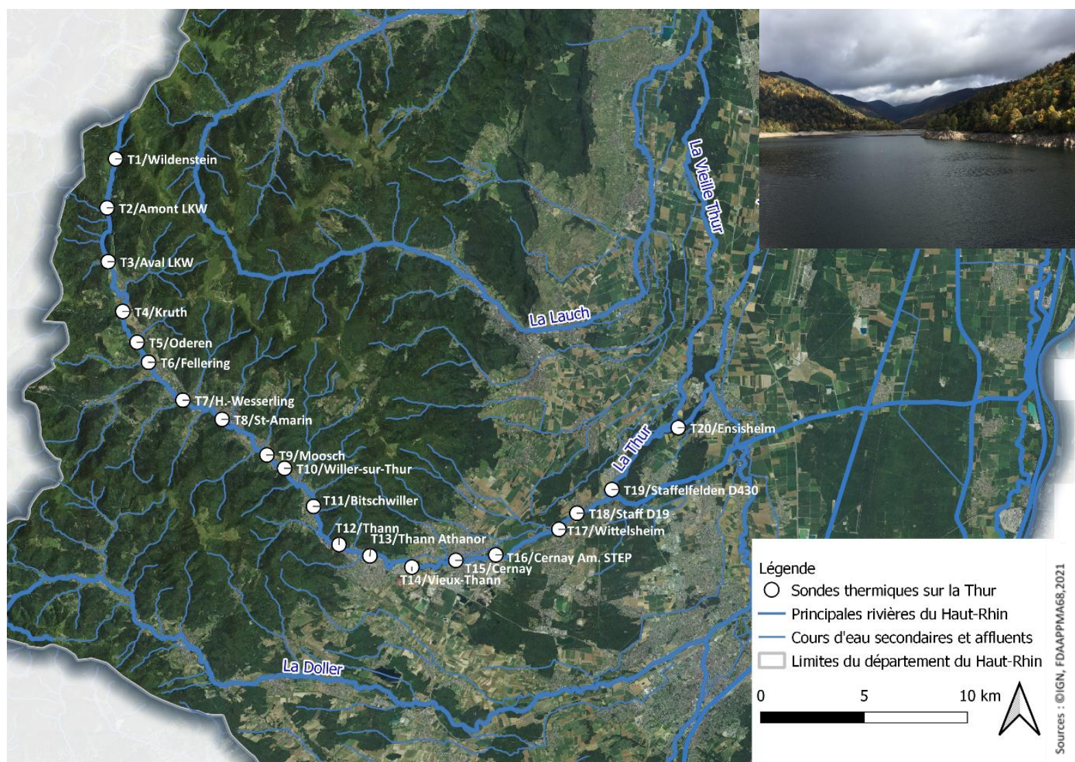
Figure 24 : Répartition du réseau de sonde thermique sur le bassin de la Thur (de l'amont à l'ouest à l'aval à l'est).
