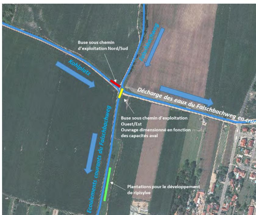
Figure 43 – Aménagement au niveau du croisement des 2 chemins d'exploitation
