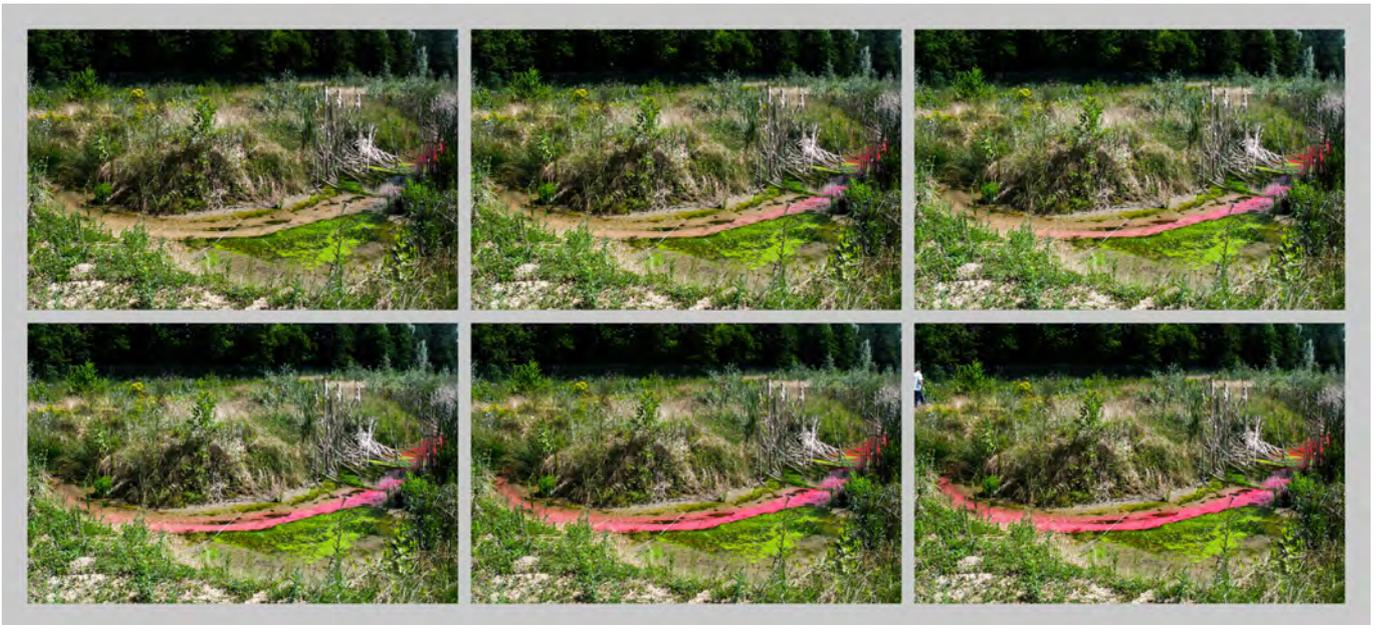
FIGURE 3.8 – Dissipation de la sulforhodamine B dans la ZRV de Wahlbach
