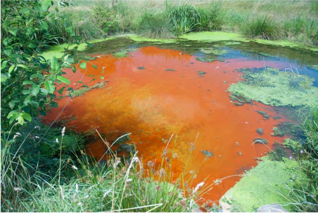
FIGURE 3.17 – Dissipation des traceurs fluorescents dans la ZRV de Lutter (b)
