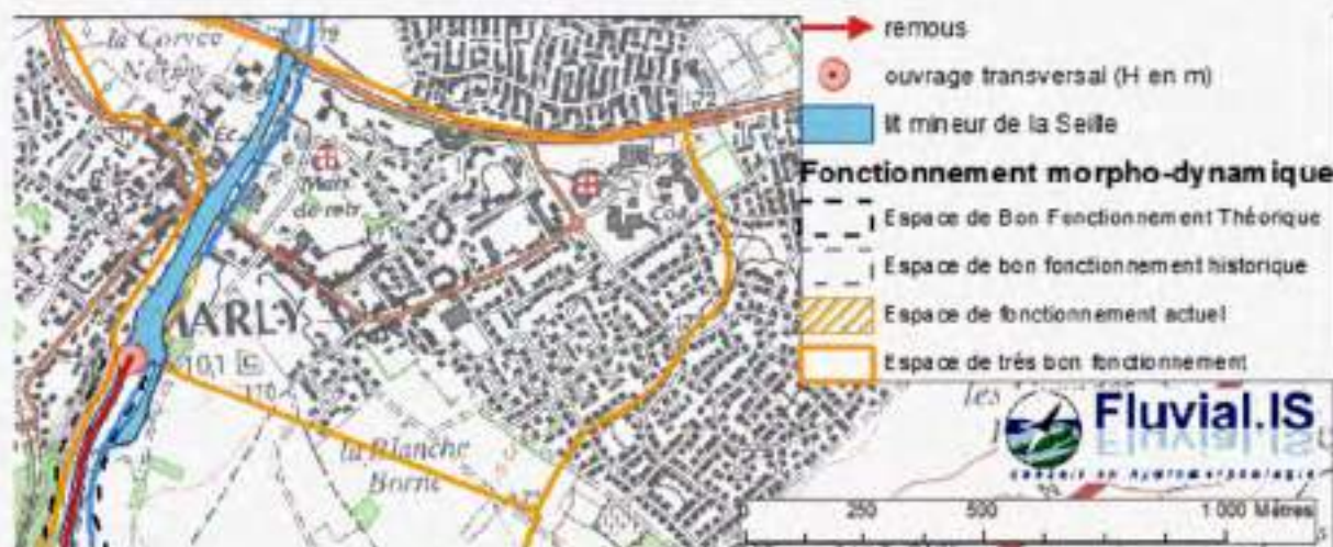
Figure 54 : cas d'une surlargeur. A Marly (57), la Seille présente une surlargeur du lit mineur à l'aval de l'ouvrage hydraulique. La largeur de l'EBF et de l'EFA a donc été calculée sur la base de la largeur théorique en excluant l'espace du lit mineur qui est en surlargeur au même titre que les équipements et bâti en rives.
