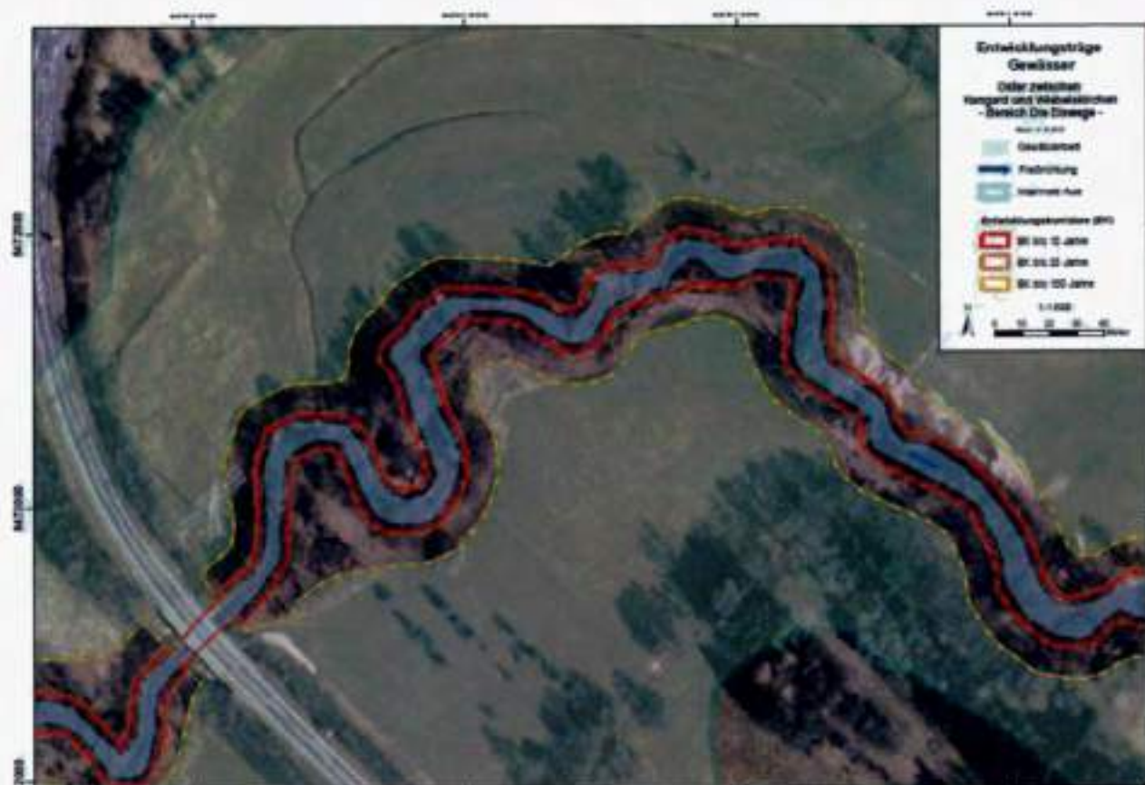
Figure 44 : exemple de cartographie de l'espace nécessaire à 3 échelles de temps (rivière Oster, Saarland, 2010)
