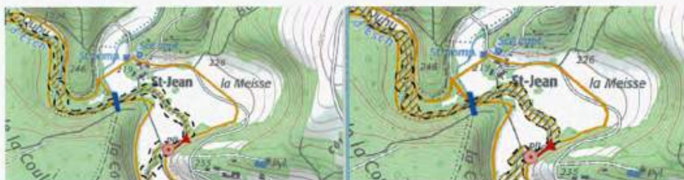
Figure 57 : le cas de l'Esch (54) : le potentiel de mobilité théorique de l'Esch est celui d'un cours d'eau Peu Mobile (PM=5 Largeurs à pleins bords). A gauche l'EFA est calculé sur la base d'un potentiel actuel correspondant à un cours d'eau Très Peu Mobile (TPM=3 la largeur à pleins bords), à droite l'EFA est calculé sur la base du potentiel de mobilité théorique inchangé (PM=5Lpb). Sur ces deux tronçons, l'effet de cette modification est faire passer la note du tronçon 1 de 30 à 67, et sur le tronçon 2 de 18 à 84. Compte tenu des
