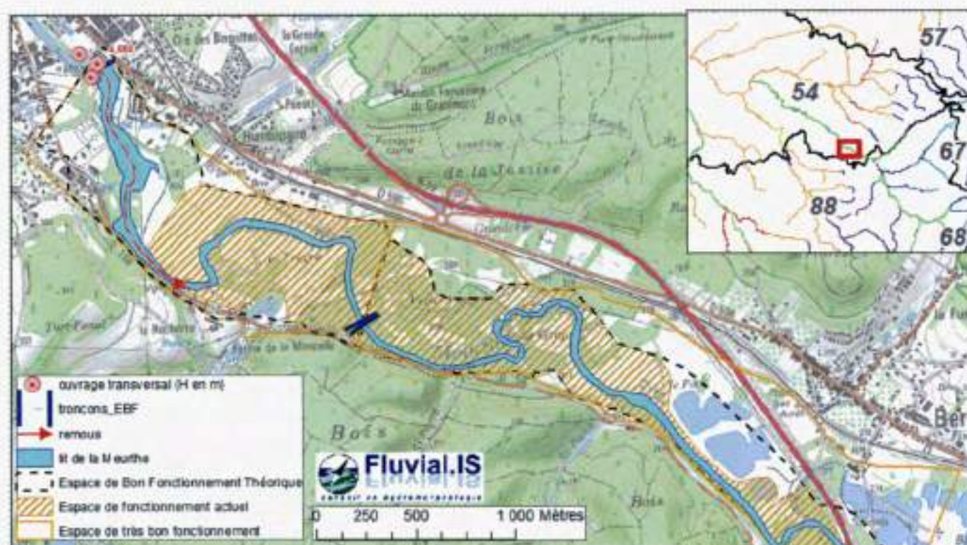
Figure 55 : l'espace de fonctionnement (EFA) de la Meurthe entre Raon-l'Étape et Baccarat
