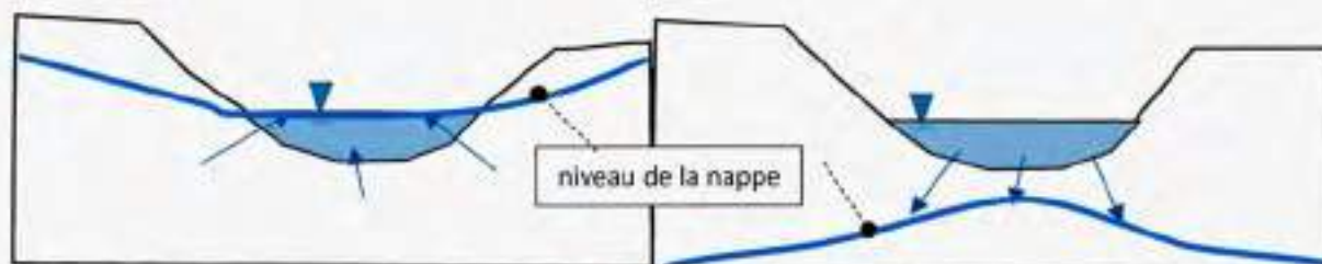
Figure 29 : drainage (à gauche) et alimentation (à droite) entre le cours d'eau et la nappe (d'après Musy et al., 1998)
