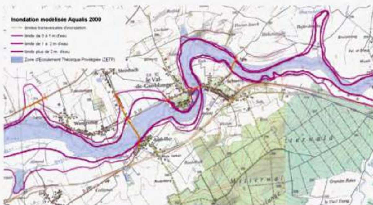
Figure 27 : la bande bleutée (5 fois la largeur du lit à partir de chaque rive) correspond approximativement à la limite d'inondation 1-2 m ou la zone inondable à 10 ans modélisée au Val-de-Guéblange (modélisation Aqualis pour DDAF-DDE57, Fluvial.IS 2010).
