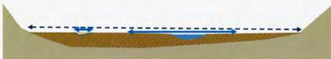
Figure 23 : profil schématisé (orangé : alluvions, brun : encaissant) la zone d'expansion maximale des crues (pointillés) est constituée par l'espace plan du fond de vallée, naturellement représenté par les alluvions modernes (hors terrasses). La zone des écoulements les plus forts est représentée par la bande de terrains les plus proches du lit mineur (grande flèche continue), plus les dépressions dans le lit majeur (en général d'anciens lit délaissés par la rivière) (petite flèche continue)
