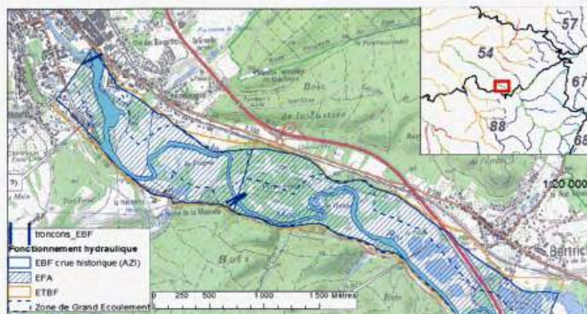
Figure 64 : l'espace de bon fonctionnement hydraulique (EBF hydraulique) entre Raon-l'Étape et Baccarat
