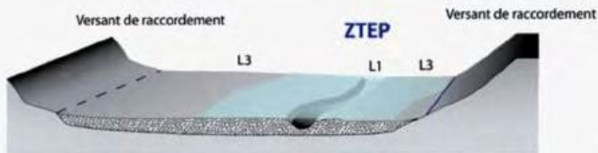
Figure 63 : principe de la ZTEP : sur la base de plusieurs cartographies de la crue décennale, on estimait, en absence de lit moyen que la zone située à moins de 5 fois la largeur à pleins bords de la rivière était également la zone qui présentait le plus fort risque d'être inondée tous les 10 ans
