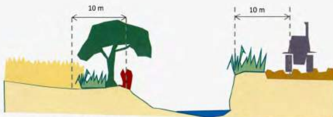
Figure 72 : principe de délimitation de la bande rivulaire de 10 m en rive, à partir du haut du talus de berge, en limites de pleins bords (la berge fait partie du lit mineur)
