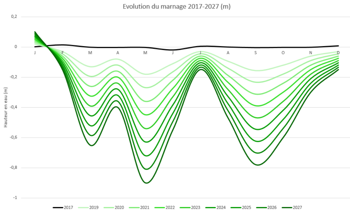
FIGURE 107 : ÉTABLISSEMENT PROGRESSIF À PROPORTION FIXE DES OBJECTIF DÉFINIS, CORRESPONDANT À UNE PÉRIODE DE 10 ANS : DIMINUTION DU NIVEAU D'EAU DE 4 CM PAR AN, ET AUGMENTATION DU MARNAGE DE +3 ET - 3 CM PAR AN. ORDONNÉES : HAUTEUR D'EAU DU LAC. ABSCISSES : MOIS.
