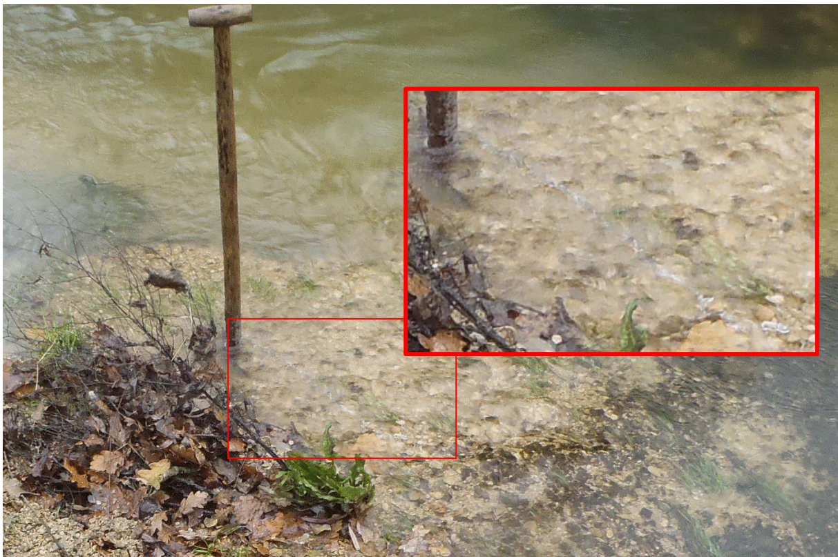
Figure 23 : principe de fonctionnement des chaînes d'érosion testées sur le Longeau
