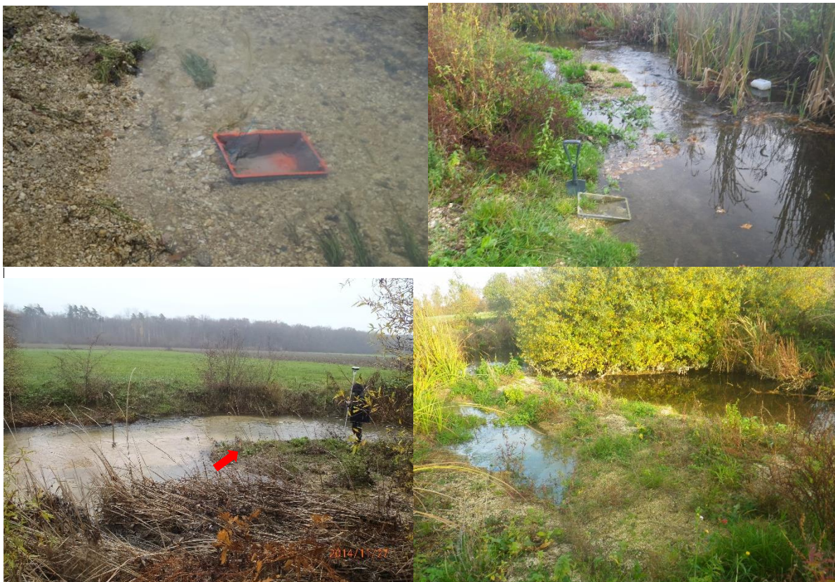
Photo 9 : Morphologie de l'atterrissement entre le 27/11/14 (série à gauche) et le 05/11/2015 (série à droite). Les matériaux semblent avoir été repris de l'amont (léger approfondissement observé au droit du piège à sédiments amont) suite à un premier épisode de transport (piège à sédiments remplis). Le dépôt semble progresser vers l'aval avec un exhaussement d'une vingtaine de centimètres. (Att03, Annexe 9)
