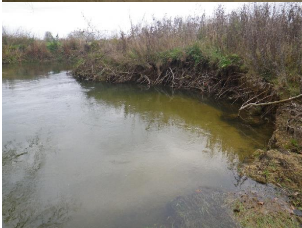
Photo 6 : A gauche : relative stabilité de berge ERO2 entre 12/14 et 12/15. A droite : léger recul de berge peu perceptible visuellement. En bas : la rive qui a subi l'érosion la plus forte a reculé de 0,5 à 0,9 m ce qui
