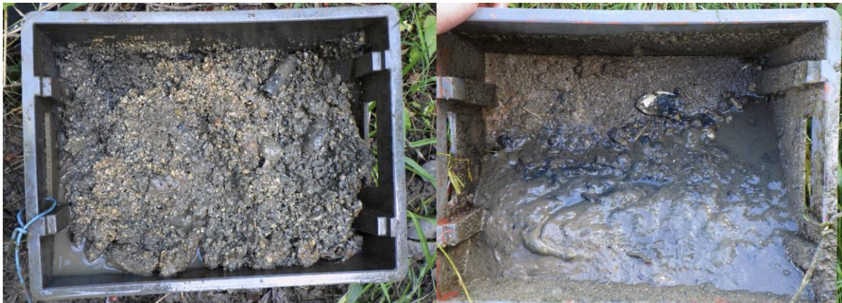
Photo 11 : remplissage des pièges à sédiments après 9 mois : à gauche le piège à l'entrée de l'annexe, à droite le piège de la partie aval de l'annexe (septembre 2015)
