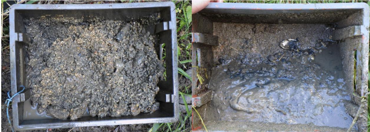
Photo 6 : remplissage des pièges à sédiments après 9 mois : à gauche le piège à l'entrée de l'annexe, à droite le piège de la partie aval de l'annexe (septembre 2015)
