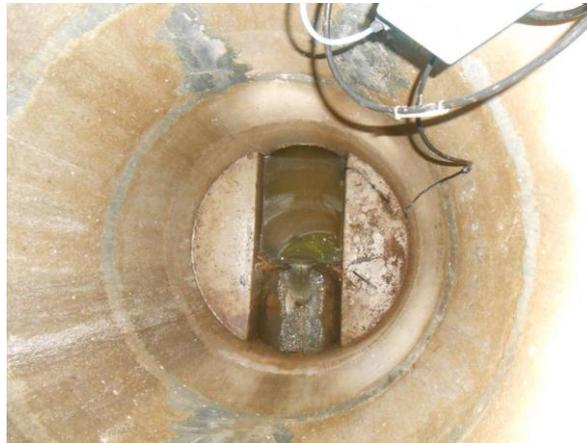
Figure 1-4 : Mesure de débit sur seuil calibré (Exemple Point Ps1)
