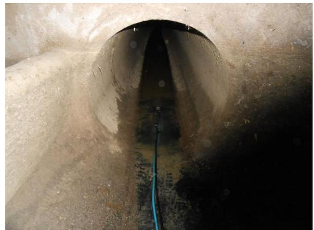
Figure 1-5 : Mesure de débit avec sonde Hauteur-Vitesse (Exemple Point Pn7)
