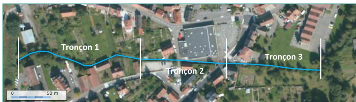
De ce fait, trois types d'opération sont retenus : la **stabilisation** et la **restauration** des berges dégradées, la **renaturation** des berges sur la partie aval du cours d'eau et la **concentration des écoulements** au droit du supermarché.
