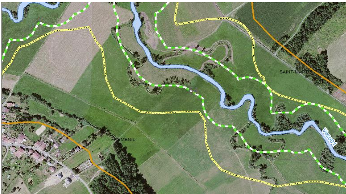
Figure 10 : la Vezouze à Fréménil : le fuseau de mobilité atteint une largeur de 320 m indépendamment des lits historiques, ce qui supposerait une largeur de plus 30 m pour le lit mineur. La largeur moyenne du lit de la Vezouze ne dépasse pas 13 m alors qu'elle avait été estimée en moyenne à 26 m en 1999. En pointillés verts nous avons figuré sur les cartes l'amplitude d'équilibre théorique calculée à partir de la numérisation des orthophotos de 2012-14
