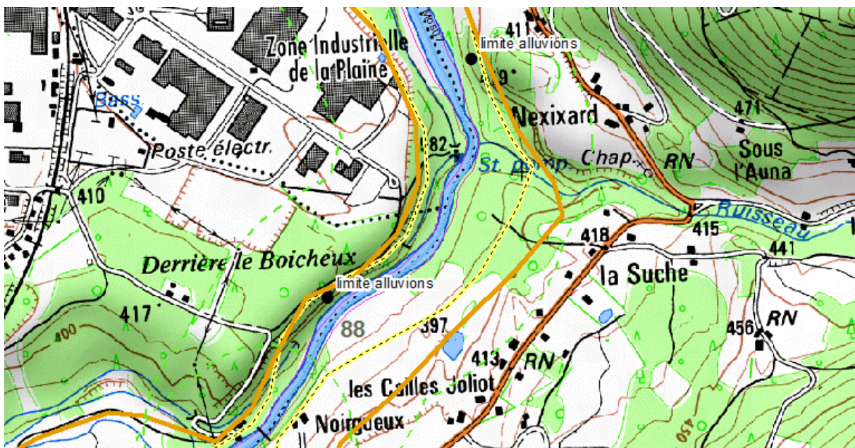
Figure 15 : un exemple de la limite des alluvions dessinées en 1999 (lignes orangées en gras) qui recourent les lignes de niveau qui symbolisent les versants : l'emprise du fuseau n'est pas vraisemblable (la Moselle à l'amont d'Eloyes)
