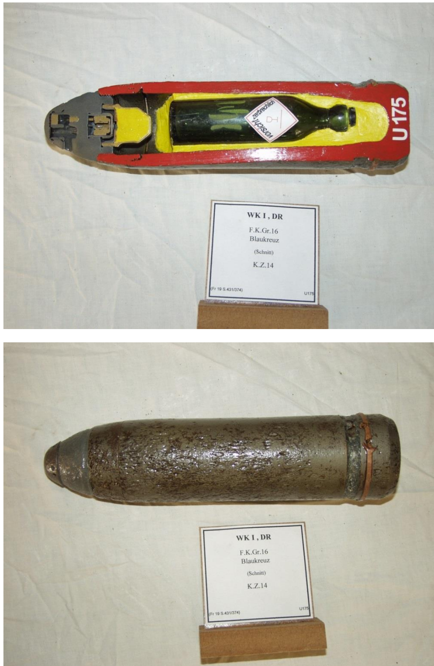
Figure 13 : Obus à « Croix bleue » de 77 mm avec écorché (source : H. Bélot) 29 .
