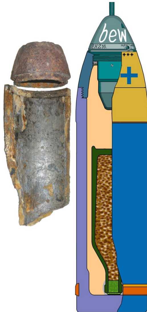
Figure 14 : Munition à « Croix bleue » de 105 mm et éléments de munitions découverts sur la « Place à gaz » (source : H. Bélot, novembre 2014).
