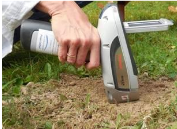
Figure 27 : Mode de mesure FX in situ (directe) sur le sol après avoir dégagé la couverture végétale.
