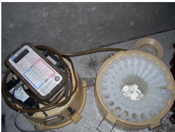
Illustration 41 : Préleveur automatique à 24 flacons
