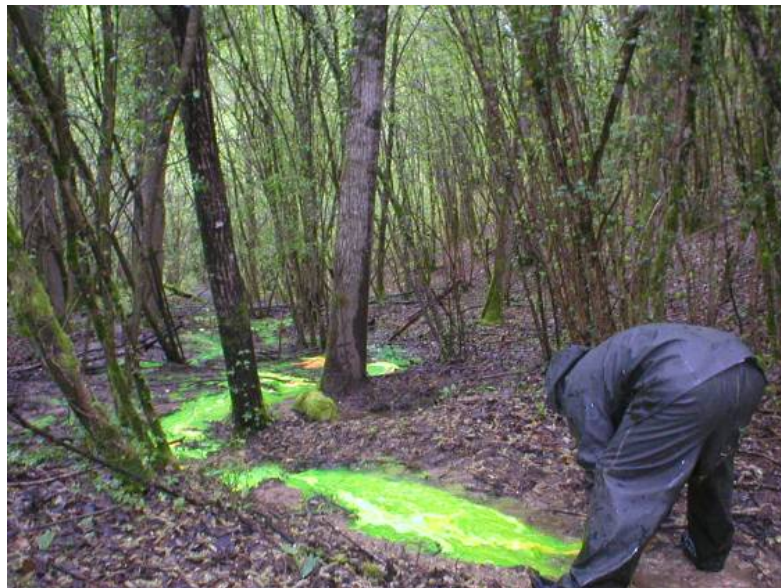
Figure 22 : Injection de la fluorescéine (Photo GINGER)
