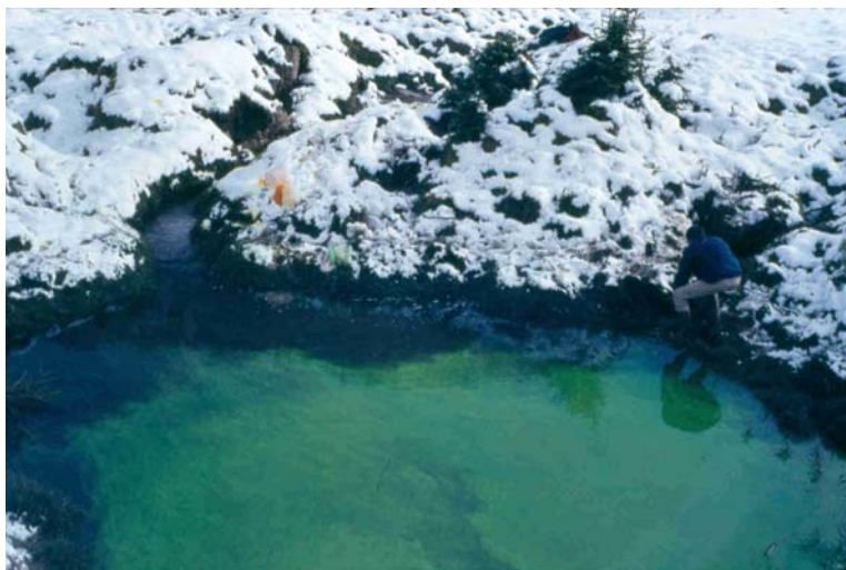
Figure 31 : Traçage des pertes de Tinnaz en hautes eaux (Cliché PH Mondain)
