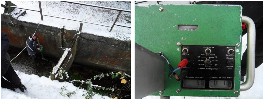
Illustration 8 : Jaugeage au micromoulinet à l'aide d'une perche de jaugeage à intégration à la station du Burbach
