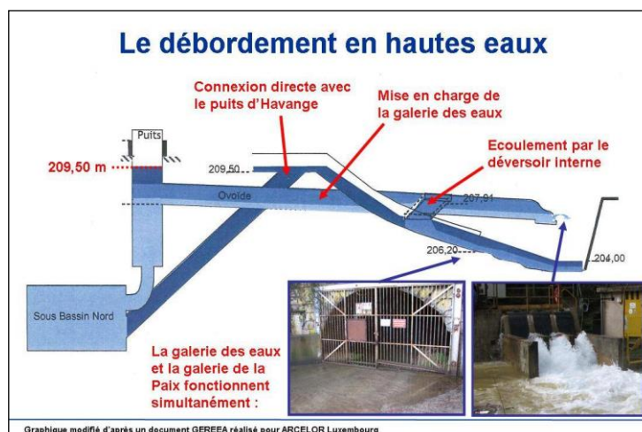
Illustration 14 : Schéma du dispositif de débordement du réservoir Nord
