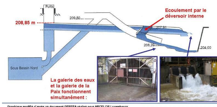
Illustration schématique du dispositif de débordement du réservoir Nord
