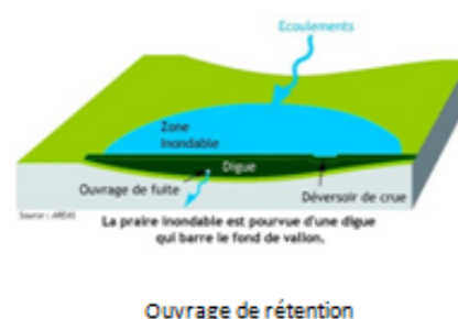
Ouvrage de rétention
