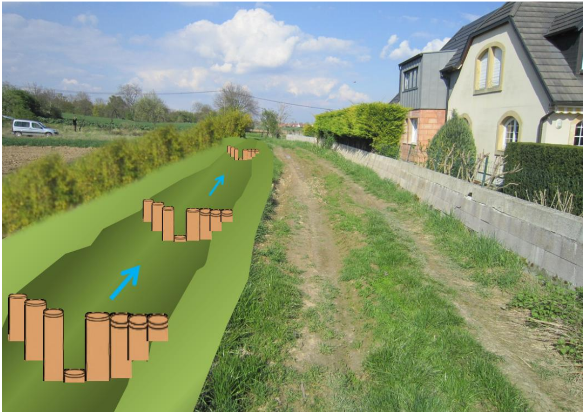
Fig. 23. SCHEMA DE L'IMPLANTATION DE HAIES ET D'UNE NOUE A L'AVAL DU BASSIN VERSANT N°2
