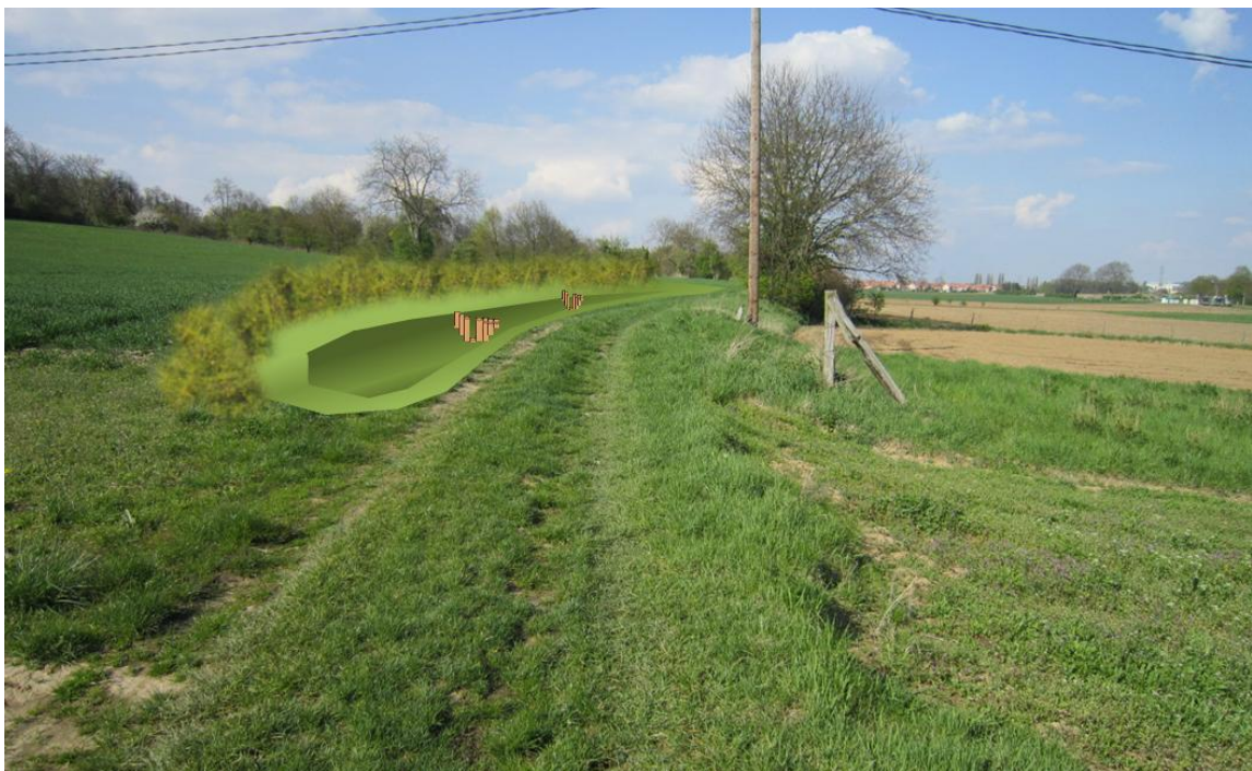
Fig. 24. SCHEMA DE L'IMPLANTATION DE HAIES ET D'UNE NOUE A L'AVAL DU BASSIN VERSANT N°3
