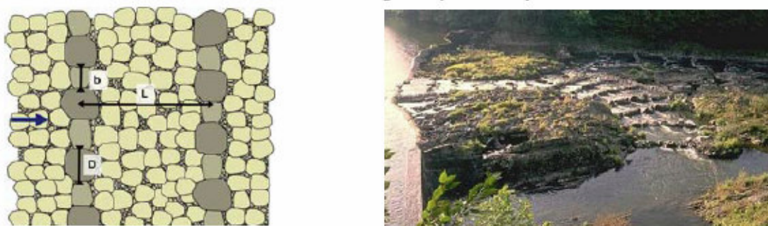
Figure 3-1 : Schéma de principe et photo d'une passe rustique à enrochements en rangées périodiques
