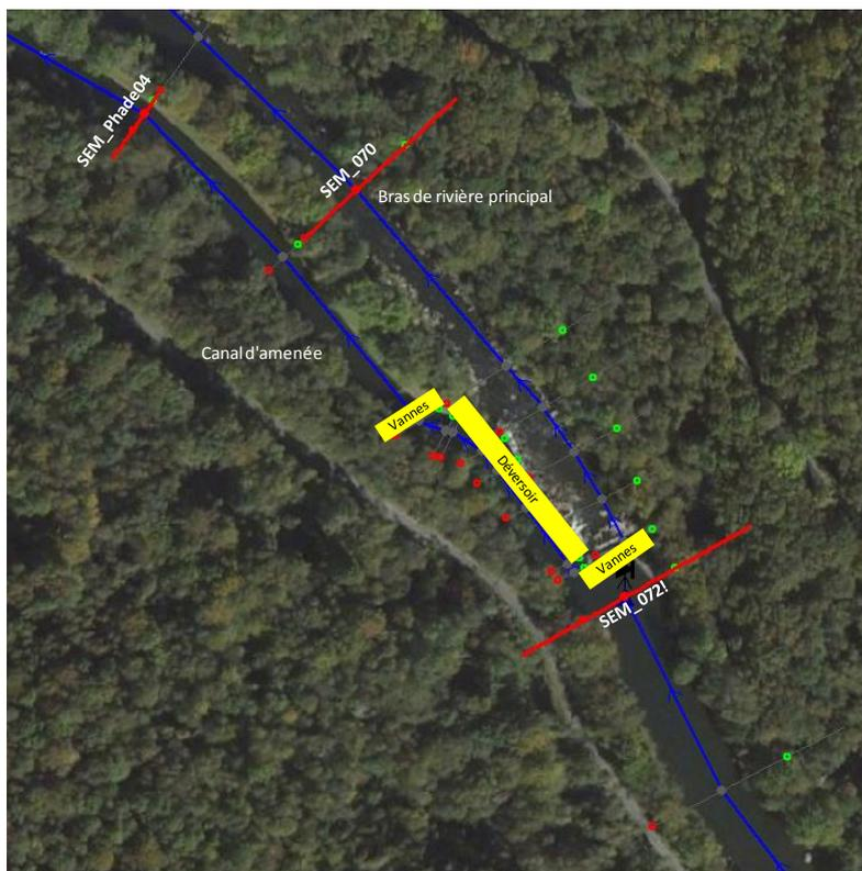
Figure 3-13 : Barrage de Phades, localisation des sections témoins (lignes rouges) et des différents équipements (en jaune).
