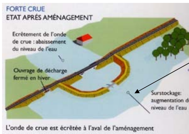
Figure 5 : Principe d'un aménagement de type surinondation s'appuyant sur un remblai routier
