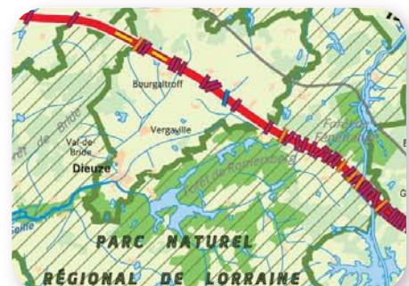
La LGV est une infrastructure fragmentante. Des passages à faune préservent la continuité Source : RFF
