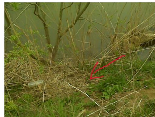
**Photo 8** : Laisse de crue observée dans un buisson + racinaire en rive droite le 15/04/2012 – Alt. relevée : 199,190 m NGF (Fluvial-IS)
