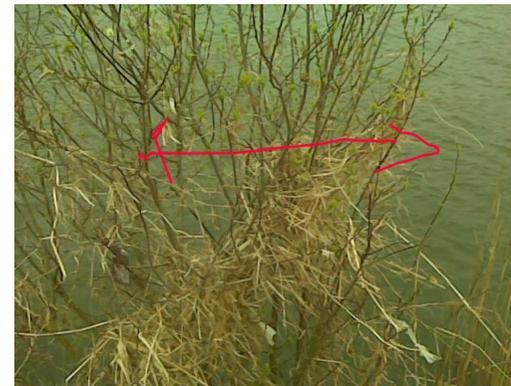
**Photo 7** : Laisse de crue observée dans un buisson en rive gauche le 15/04/2012 – Alt. relevée : 199,954 m NGF (Fluvial-IS)
