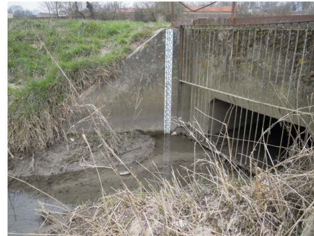
Photo 14 : Echelle limnimétrique installée au bord de la Meurthe (aval immédiat du chenal de connexion – sortie des eaux pluviales) pour le suivi des niveaux de crues (27/03/2013)
