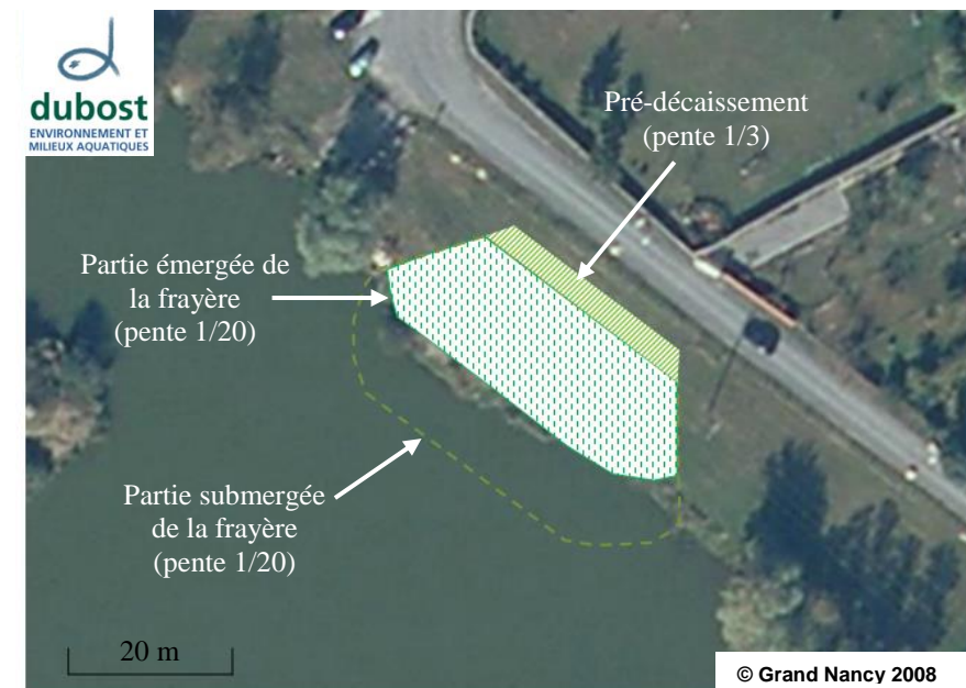
Figure 17 : Illustration schématique de l'aménagement projeté pour établir une zone de frayère potentielle sur la berge de l'étang des Croquottes
