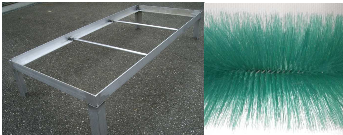
Figure 2 : Cadre en aluminium d'une frayère artificielle et balai en poils synthétiques.
