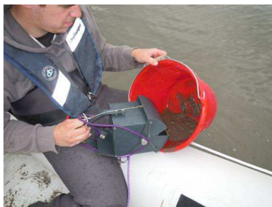
Remontée de la benne d'Ekman et récupération des sédiments collectés (Dubost Environnement)
