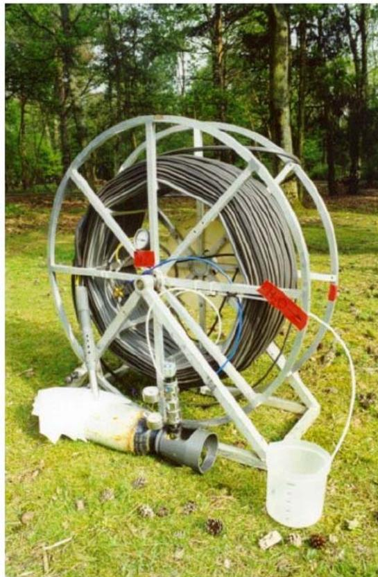
*Illustration 18 : Exemple de préleveur mobile avec 300 m de bitube rilsan protégé par un membre ne sur touret de capacité 600 m et bouteille portable d'azote sous pression*
