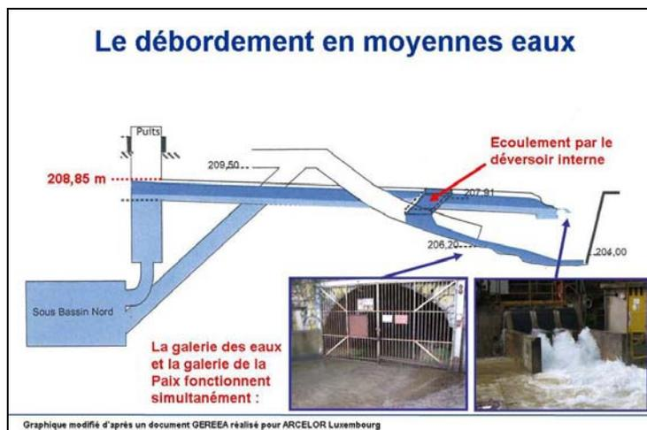
**2) En période de moyennes eaux :** lorsque le niveau du réservoir dans le puits d'Havange dépasse la cote 208,85 m NGF, soit pour un débit de débordement supérieur à 2,3 m<sup>3</sup>/s, la galerie des eaux se déverse dans la partie aval de la galerie de la Paix par l'intermédiaire du déversoir interne ; et les deux galeries de débordement fonctionnent simultanément. Cette configuration a été observée en 2008 uniquement
