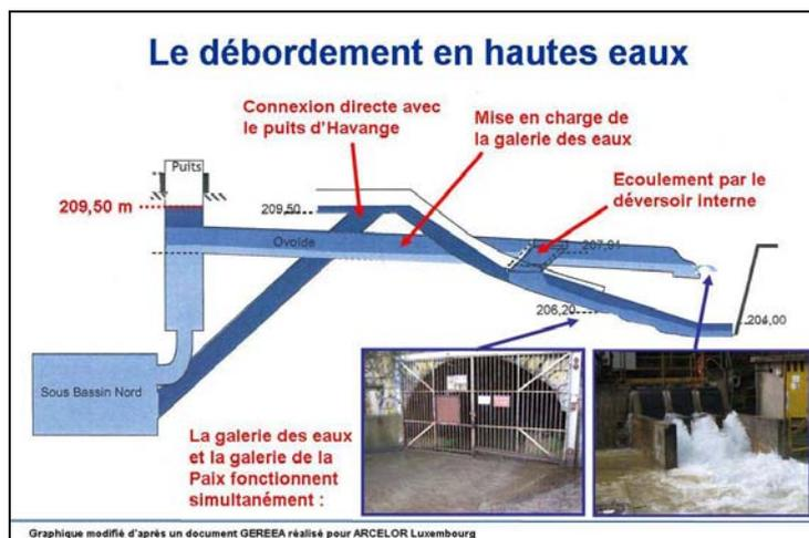
**3) En période de hautes eaux :** lorsque le niveau du réservoir dans le puits d'Havange dépassera la cote 209,50 m (débit estimé supérieur à 5 m<sup>3</sup>/s), la galerie des eaux sera totalement remplie d'eau, et la galerie de la Paix débordera depuis sa partie amont, par une jonction directe avec la base du puits d'Havange. Ce fonctionnement n'a pas encore été observé.
