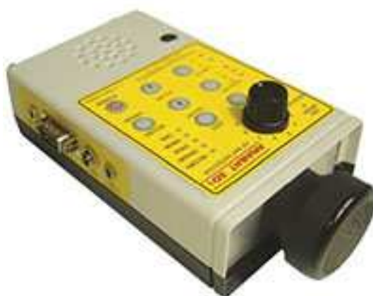
Figure 9 : Détecteur-enregistreur de type Anabat
