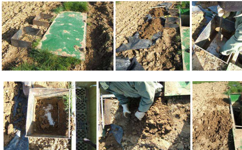
Photographie 14. Remise en place des dispositifs enterrés de collecte des eaux gravitaires (avril 2005)
