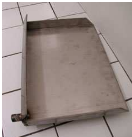
Photographie 10. Plaque lysimétrique (30 x 40 cm) en inox (316L)
