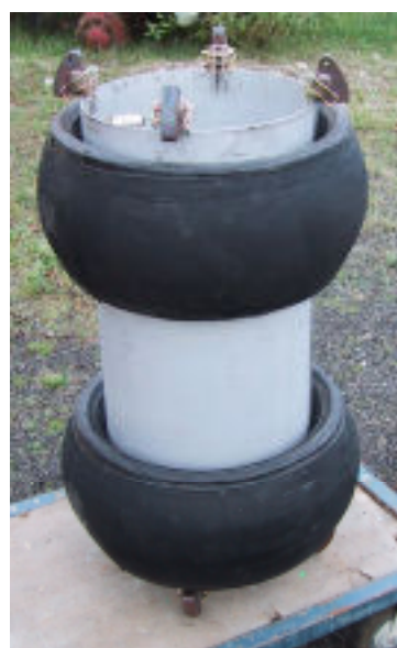
Photo 1 : Packer pour test ponctuel d'étanchéité
