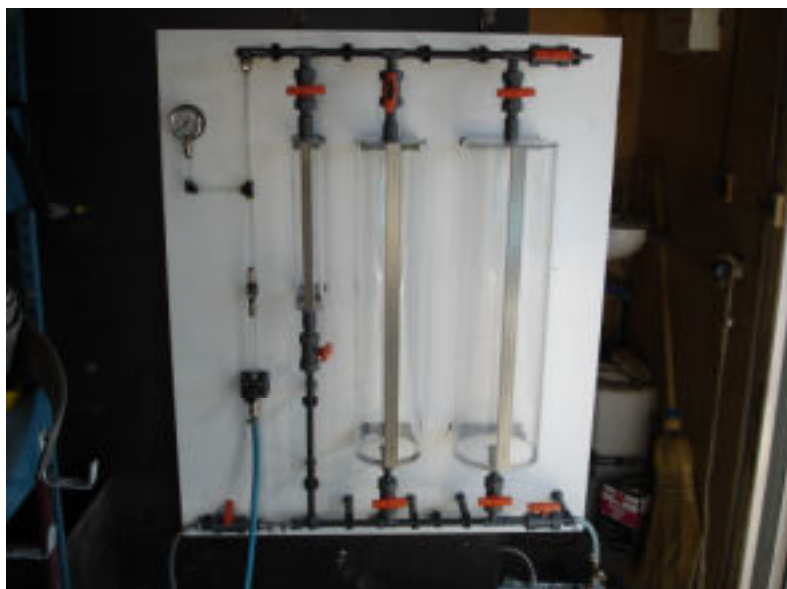
Photo 1 : Vue des trois réserves d'eau calibrées du dispositif de mesure de fuite (LRPC de Nancy)
