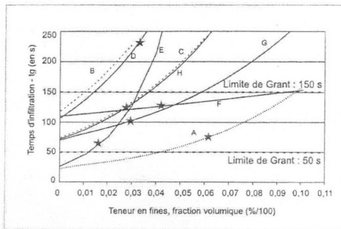
▲ Figure 4 – Évolution des temps d'infiltration [t<sub>g</sub>] en fonction de la teneur volumique en fines (les sables concassés sont représentés par des courbes en pointillés - quand cela est possible, les étoiles symbolisent la teneur volumique en fines des sables).
