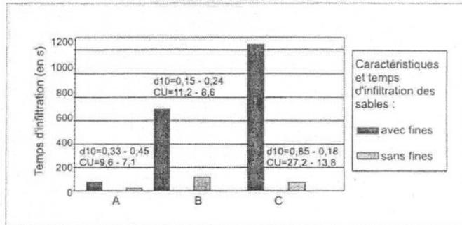
▲ Figure 3 – Influence des fines sur le d10, le CU et le temps d'infiltration [t<sub>g</sub>] pour 3 sables concassés.
