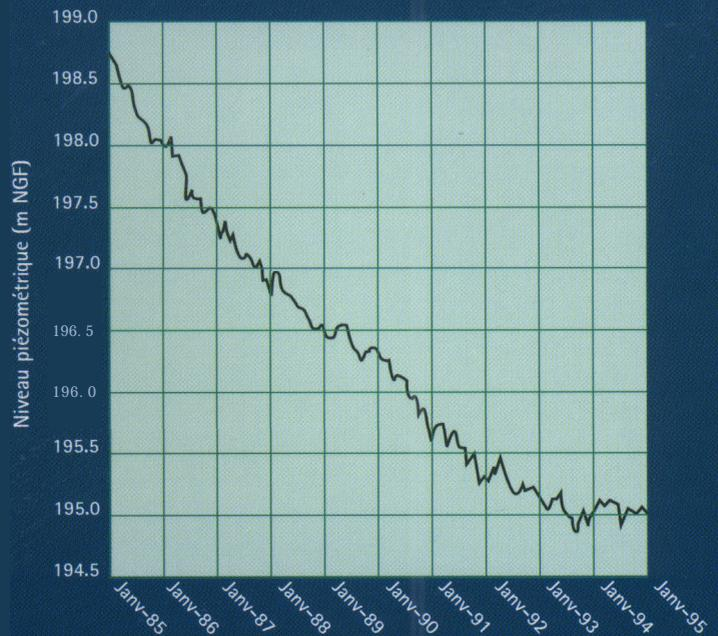
Le réseau d'observation piézométrique géré par la DIREN/SEMA permet de suivre l'évolution des niveaux de la nappe (exemple du forage de Puttelange-aux-Lacs pour la période 1985-1995).
