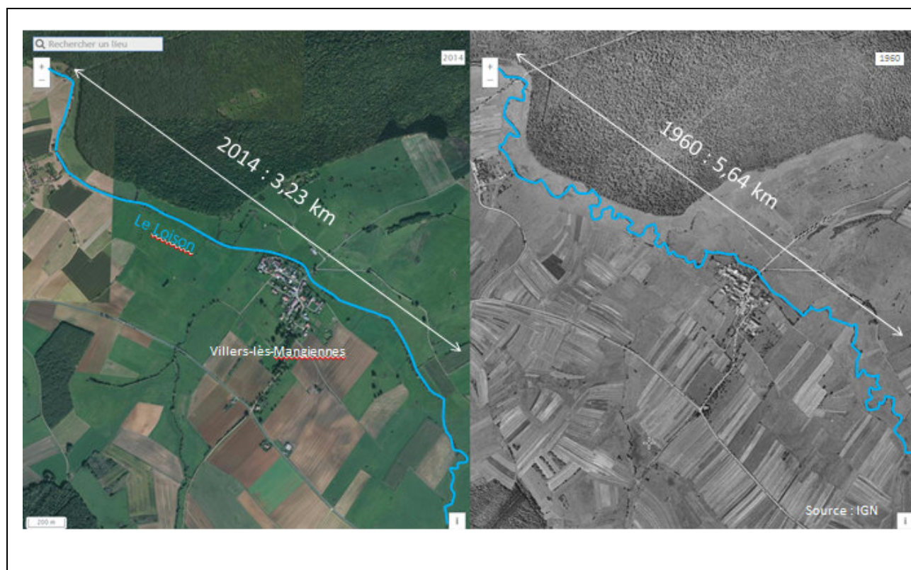
Figure 66 : Illustration de la forte perte de linéaire du Loison depuis 1960. A hauteur de Villers-Les-Mangiennes, le cours d'eau a perdu 40% de son linéaire suite aux travaux pour faciliter les opérations de remembrements et de drainage agricole entreprises dans les années 60 (source des données : Géoportail)
