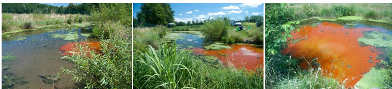
Figure 26 : Dissipation des traceurs fluorescents dans la ZRV de Lutter une dizaine de minutes après l'injection
