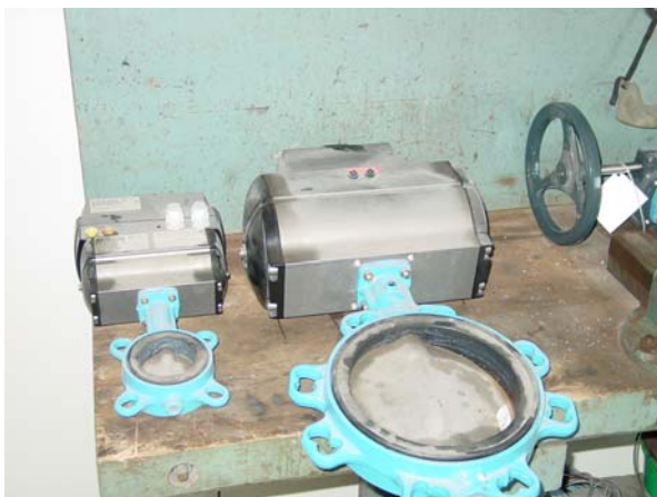
27 : Vannes de rechange
